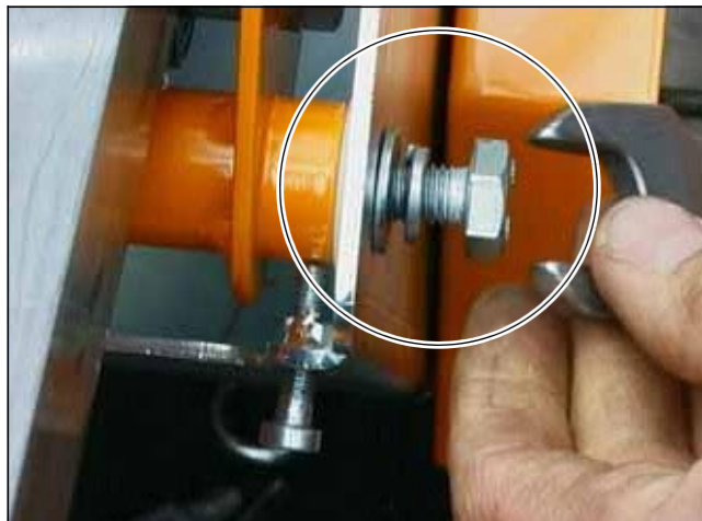
Рис. 5.14 Затягивание винта М10 на нижнем поворотном шарнире
