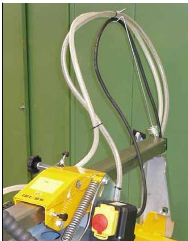
Рис. 3.8 Держатель кабеля и шланга вставлен, кабель и водяной шланг проведены
