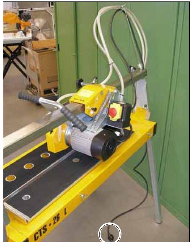
Рис. 3.14 230 В / 50 Гц сетевой кабель
