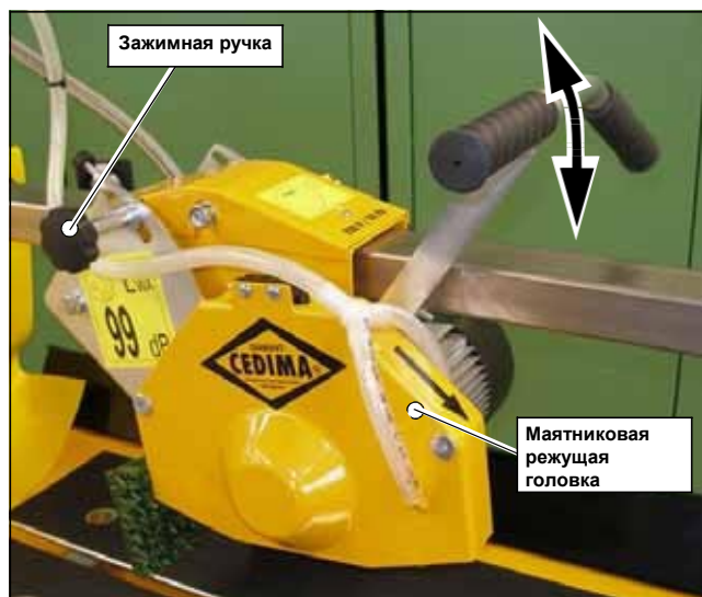
Рис. 3.9 Покачивание режущей головки
