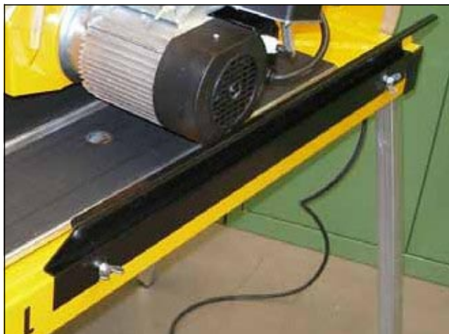
Рис. 3.6 Боковой защитный брызговик смонтирован
