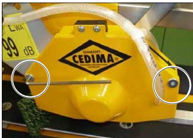
Рис. 3.20 Круглые гайки на крышке кожуха диска
