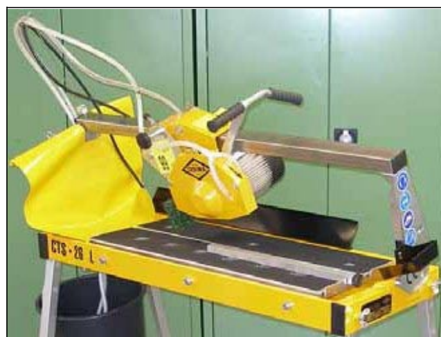
Рис. 3.28 Направляющая шина наклонена для резки под углом
