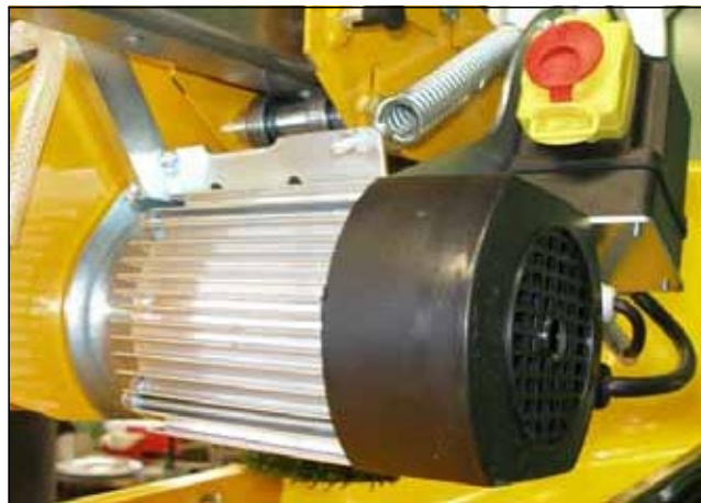
Рис. 5.5 „Чистый“ двигатель привода диска
