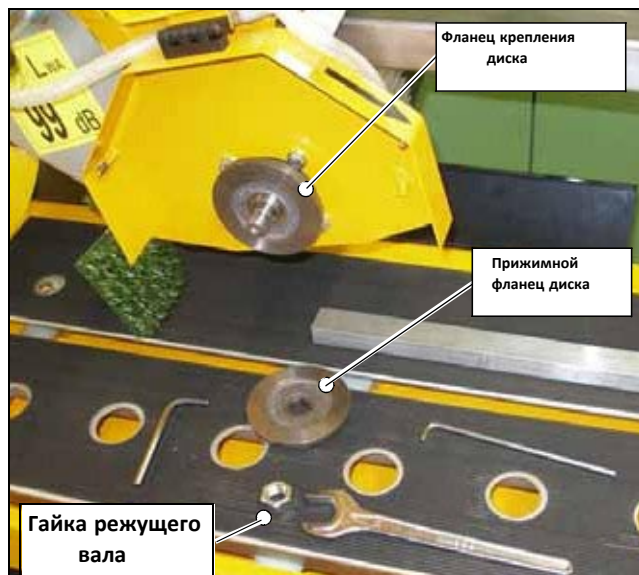
Рис. 3.23 Открытый защитный кожух диска
