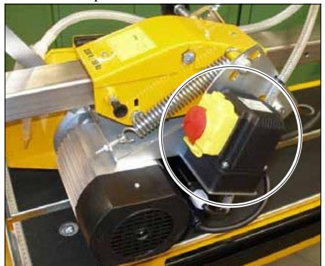
Рис. 3.15 Главный выключатель с аварийной кнопкой
