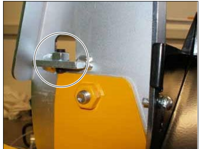
Рис. 5.19 Упор 90° установки угла резки
