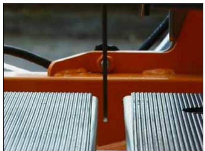
Рис. 5.20 корректировка центрального положения диска
