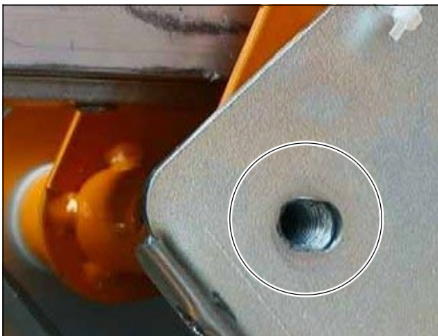
Рис. 5.10 Продольное отверстие в нижней поворотной опоре (для лучшей демонстрации винт снят)
