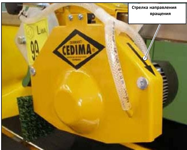
Рис. 3.24 Стрелка направления вращения на кожухе диска
