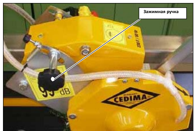
Рис. 5.12 Зажимная грибовая ручка установки глубины резки
