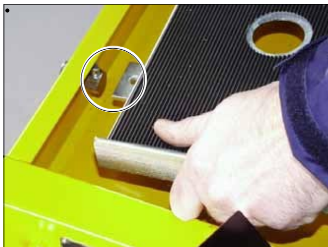
Рис. 5.1 Крепление рабочего стола
