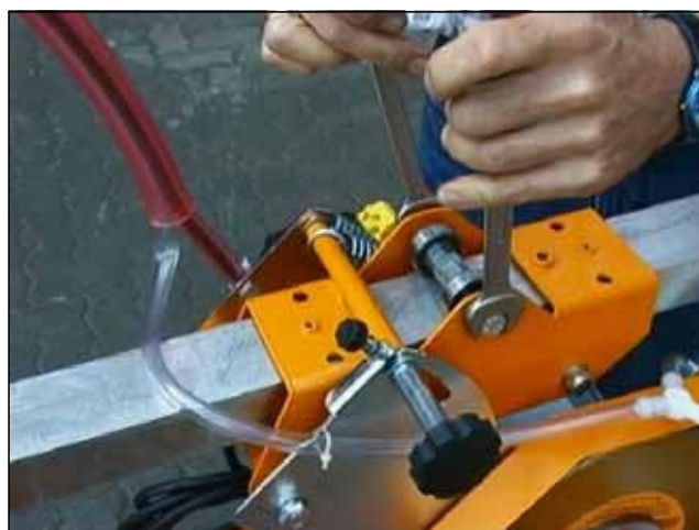
Рис. 5.8 Отвинтите крепежный винт подшипника
