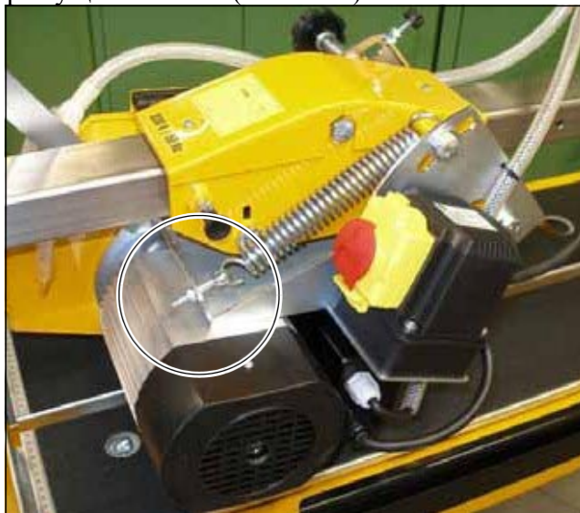
Рис. 5.24 Возможная регулировка компенсирующей пружины режущей головки
