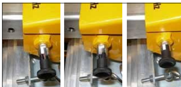
Рис. 3.11 Установка ограничителя: Снят / положение подпирания / зафиксирован
