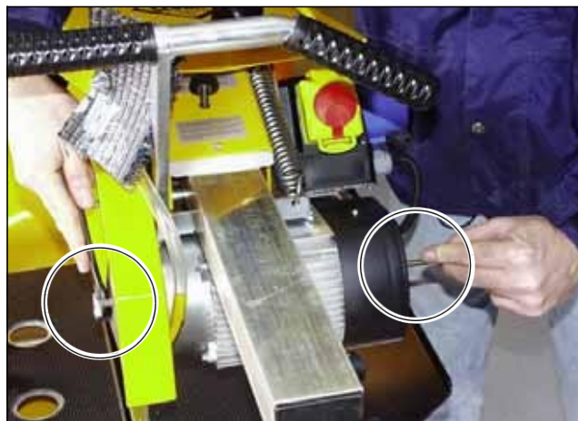
Рис. 3.22 Отвинчивание гайки режущего вала с удерживанием режущего вала
