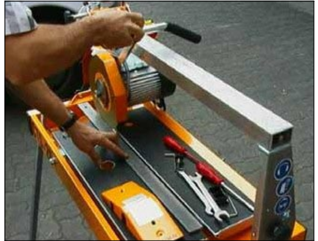
Рис. 5.11 Наложите линейку или стальной лист
