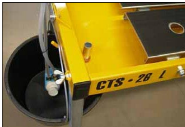
Рис. 3.17 Погружной насос в ведре, вставлена переливная трубка
