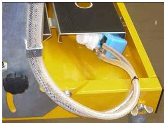
Рис. 3.18 Погружной насос в водяной ванне
