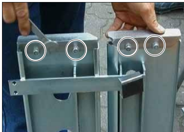
Рис. 5.15 Крепежные гайки М8 оконечного упора
