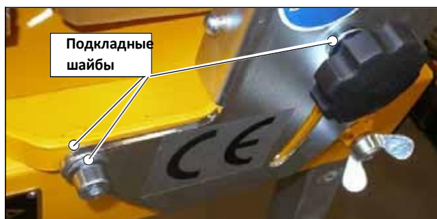
Рис. 3.3 Соединительные элементы верхней конструкции
