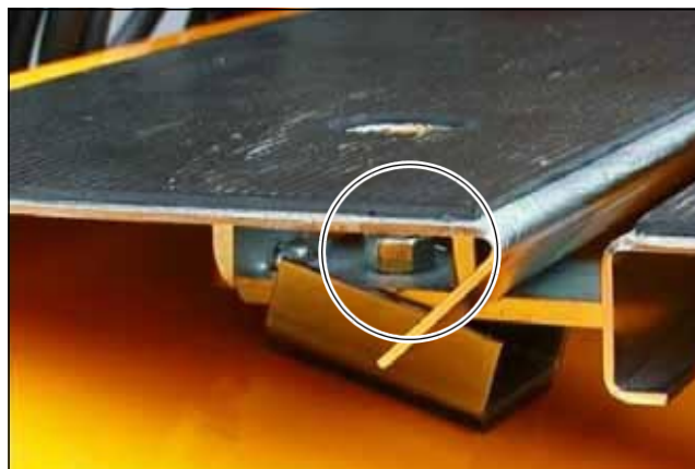
Рис. 5.23 Регулировочные винты подножки рабочего стола
