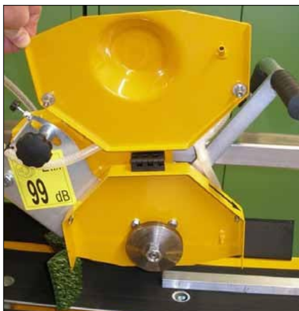
Рис. 3.20 Круглые гайки на крышке кожуха диска
