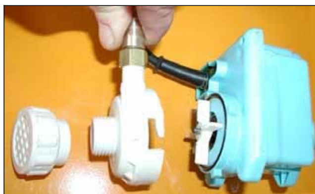
Рис.5.4 Сняты сетка и крышка погружного асоса
