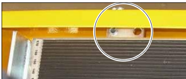
Рис. 3.5 Крепление рабочего стола на раме
