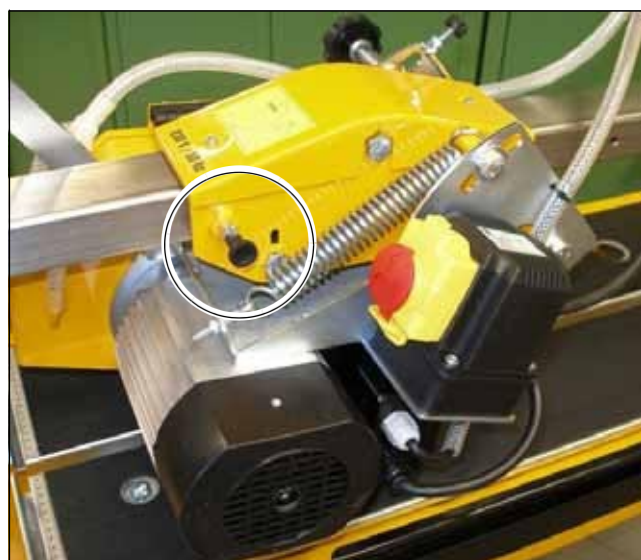
Рис. 3.10 Стопор на салазках
