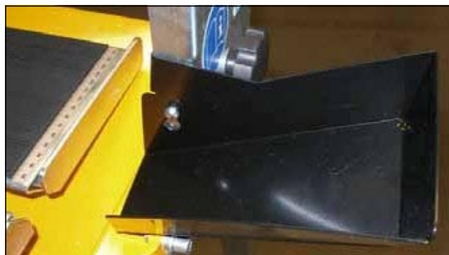
Рис. 3.7 Передний защитный брызговик навешен
