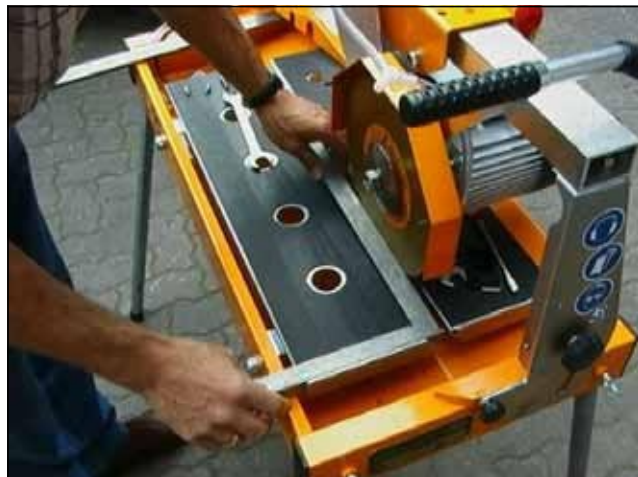
Рис. 5.16 Наложите стальной уголок 90°
