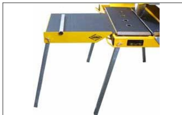
Рис. 3.29 Боковой стол приставлен (боковой упор настольной пилы размещен на приставном столе)
