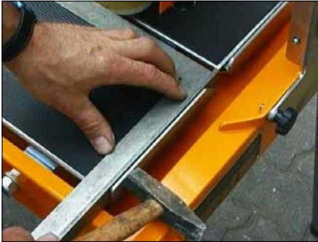
Рис. 5.17 Выравнивание окончного упора рабочего стола
