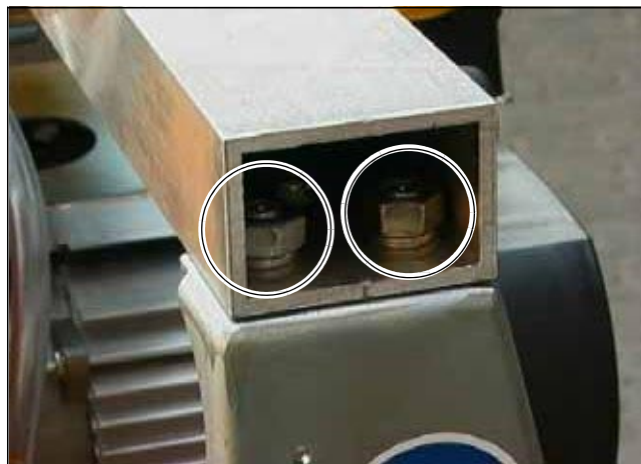
Рис. 5.21 Крепежные винты направляющей шины (после снятия резиновой заглушки)
