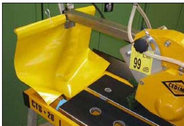
Рис. 3.13 Защитный брызговик смонтирован
