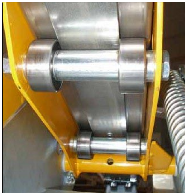
Рис. 5.6 „Чистая“ направляющая шина и подшипники маятниковой режущей головки (вид снизу)
