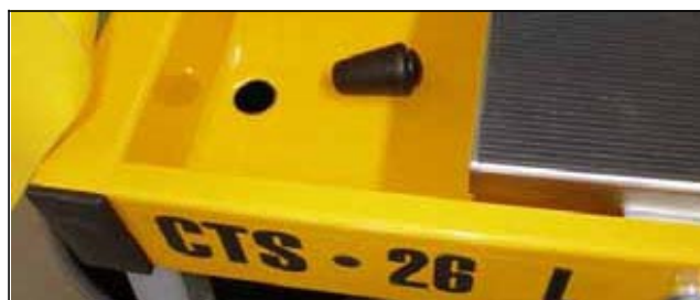
Рис. 3.19 Сливное отверстие в водяной ванне (с пробкой)
