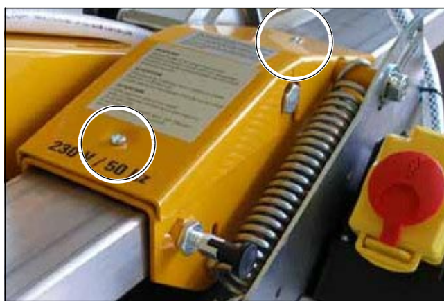
Рис. 5.7 2 крепежных винта на крышке направляющих салазок
